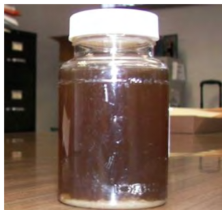
Septic tank effluent
